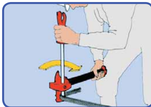
2. Bending flat iron - axe blade.
